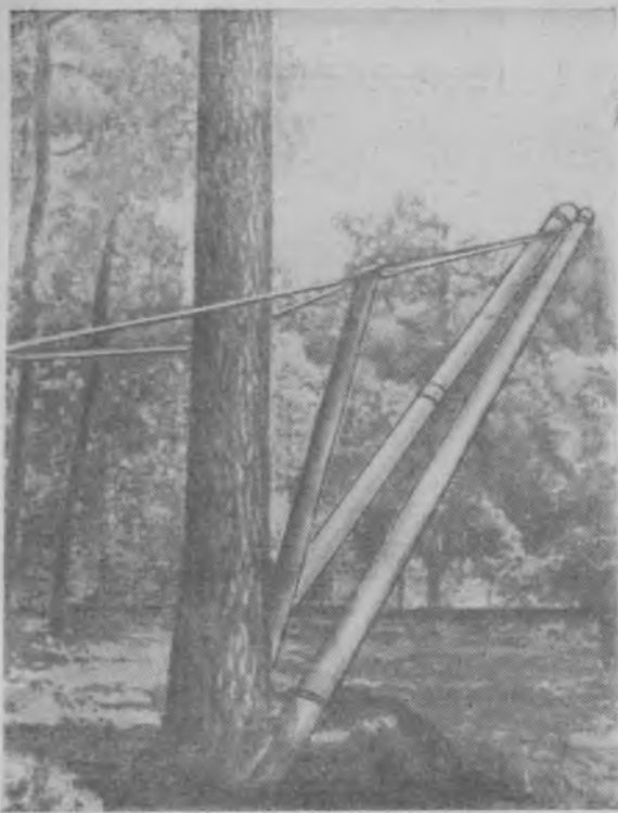
Рис. 1. Валочная стрела подведена к стволу сосны с диаметром 84 сантиметра.
