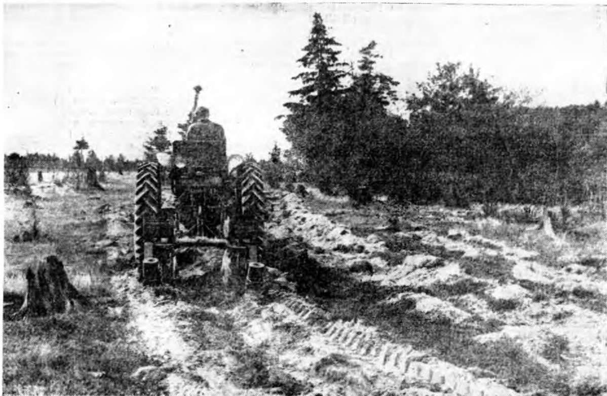
Рис. 4. Механизированный посев хвойных семян культиватором ДЛКН—6/8 (в агрегате с трактором Т-28).
