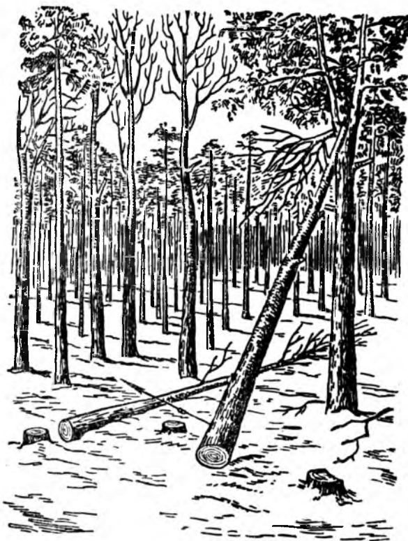
Рис. 2. Снятие зависшего дерева способом поперечного волочения.
