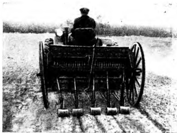
Рис. 2. Реконструированная сеялка для посева сосновых и других мелких семян (в агрегате с трактором ДТ-20) в рабочем положении.
