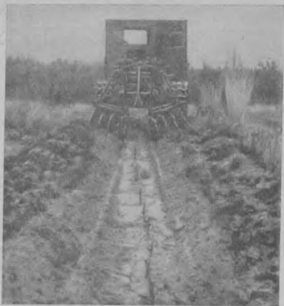
Дисковый культиватор конструкции ВНИИЛМ в работе.
