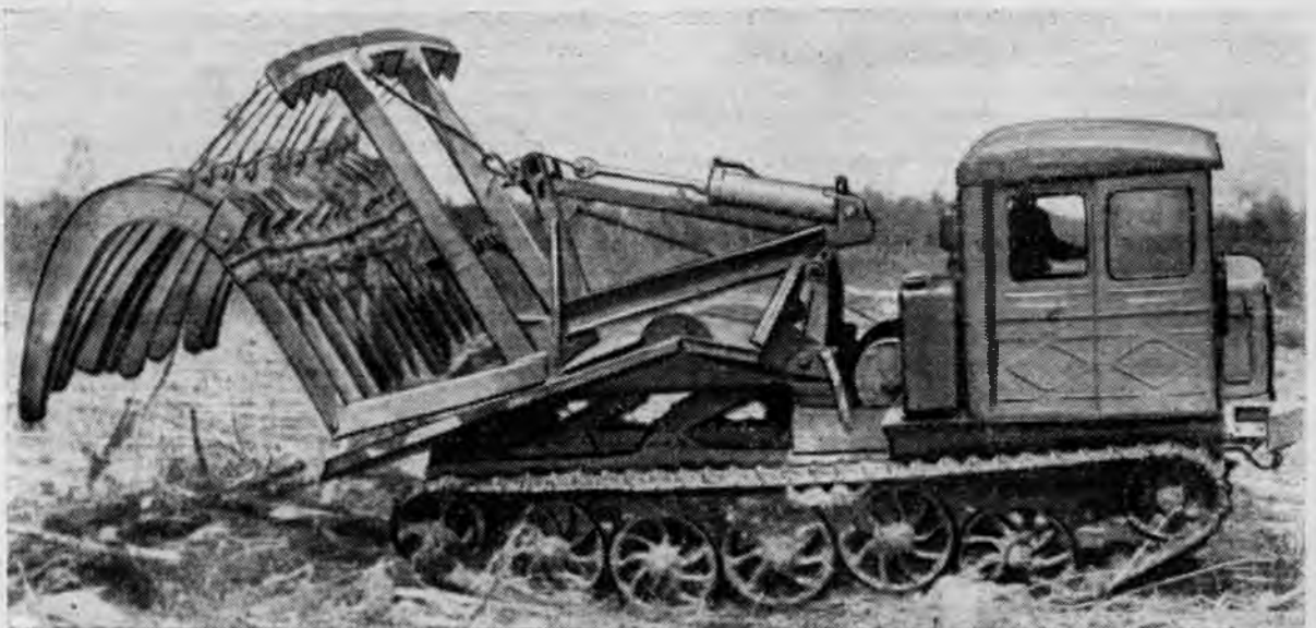
Рис. 2. Общий вид подборщика ПС-2 ЦНИИЭ с гидравлическим приводом рабочего органа.
