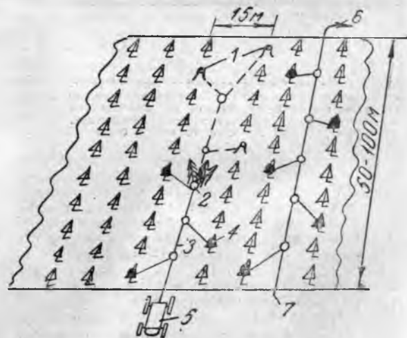
Технологическая схема механизированной трелевки древесины от рубок ухода в культурах сосны по методу П. И. Маршешева: 1 — срубленные деревья; 2 — подготовленный к трелевке пучок древесины; 3 — трелевочный трос; 4 — подготовленные к валяк закоркованные деревья; 5 — трактор на просеке; 6 и 7 — направление трелевки.
