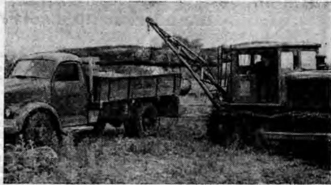
Рис. 3. Погрузочная стрела в работе (погрузка бревна на автомашину).
