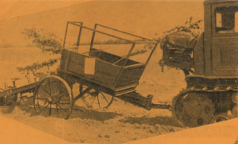
Посадка леса крупномерными саженцами может осуществляться машиной, изобретенной главным механиком Воронежского управления лесного хозяйства и охраны леса Н. Ф. Бростовским.
