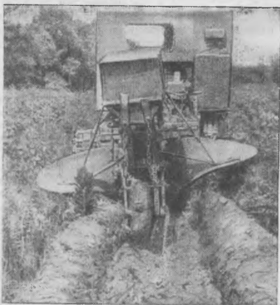
Посев желудей сеялкой на плуге ПКЛ-70 в агрегате с трактором ДТ-40.
