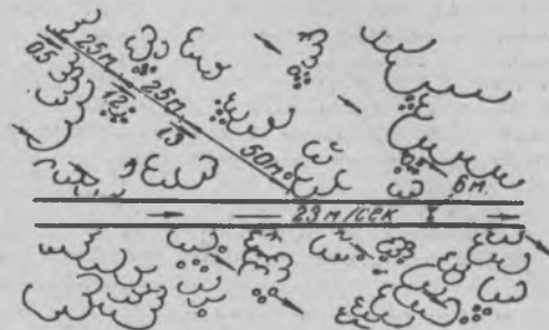
Рис. 2. Противопожарный разрыв изменяет направление ветра, дующего под углом к разрыву.
