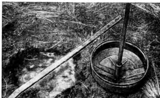
Скважина глубиной 140 см и диаметром 30 см, подготовленная буром
