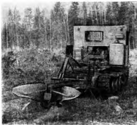
Рис. 4. Прокладка борозд плугом ПКЛ-70
