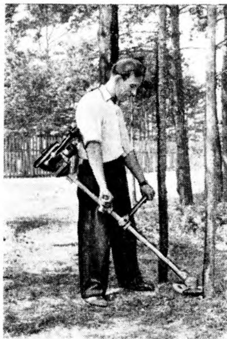
*Ранцевый лесной мотоагрегат РА-1*
