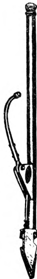
Рис. 4. Древесный инжектор «Джим-Джем» (США)
