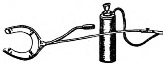
Рис. 1. Ранцевый опрыскиватель с подковообразным рабочим органом для базальной обработки (США)
