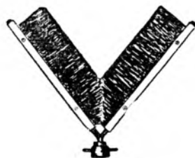
Рис. 3. Рабочий орган со щетками к ранцевому опрыскивателю «Помоза» (ГДР)
