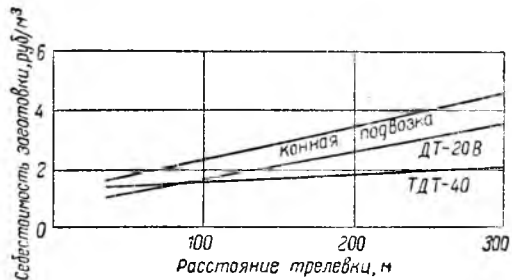
Рис. 5. Зависимость себестоимости заготовки 1 м 3 древесины от расстояния трелевки (средний объем хлыста 0,10 м 3 )
