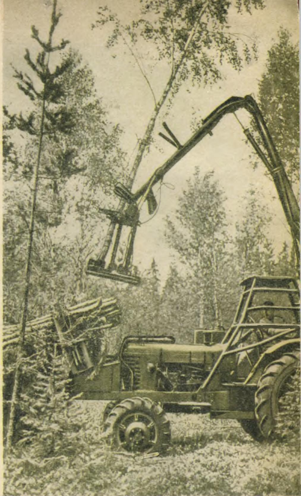
Машина «Дятел-1». Разработана в Латвийском научно-исследовательском институте лесохозяйственных проблем. Предназначена для комплексной механизации работ в лесах.
