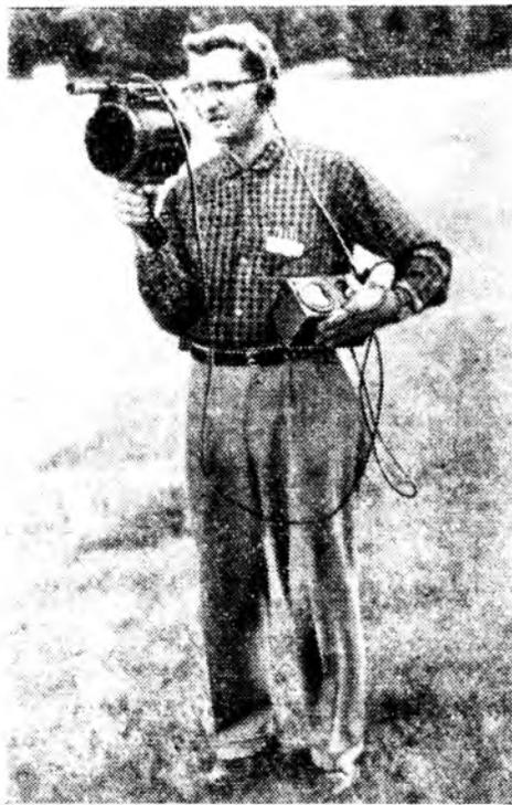
*Рис. 9. Внешний вид портативной ручной ИК-системы для наземного обнаружения очагов возгорания*
