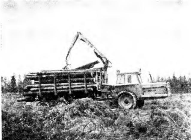
Погрузка балансов на вырубке в районе Кеуруу при помощи грейферного самопогрузчика
