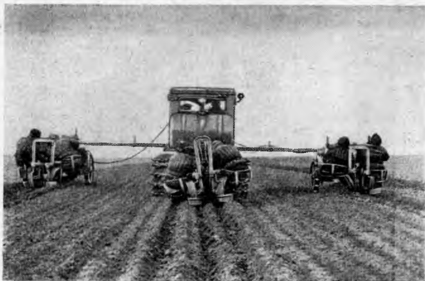
Агрегат лесопосадочных машин СЛН-1, переоборудованных для ручной подачи семян в посадочное место
