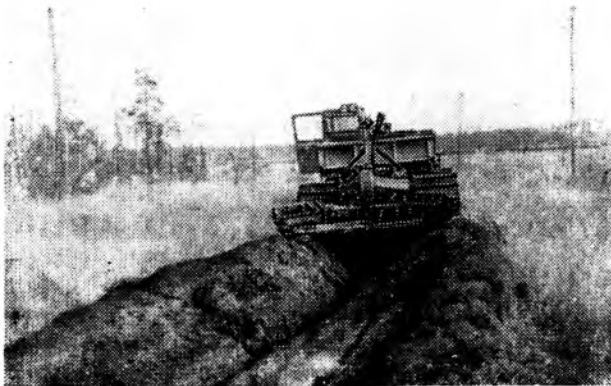
Рис. 1. Болотоходная модификация трактора ЛХТ-55 с навесным канавокопателем ПКНЛ-500А в работе
