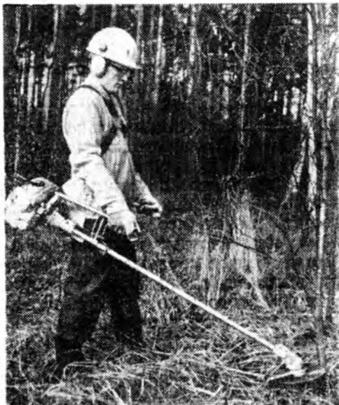
Кусторез «Секор-3» с двигателем от бензиномоторной пилы «Тайга-214»
