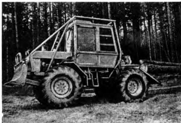
К числу агрегатных машин для комплексной механизации лесосечных работ принадлежат «Дятел-1», «Дятел-2» и ЛП-17. Лучшей из этой группы следует признать машину «Дятел-2», которую успешно можно использовать на рубках ухода в средневозрастных и приспевающих насаждениях, а также на постепенных и выборочных рубках. Вместе с тем она отвечает всем лесоводственным требованиям. Машина ЛП-17 больше приспособлена для группово-выборочных и полосных постепенных рубок.
