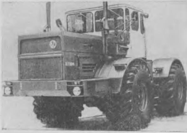
Трактор общего назначения К-710М класса тяги 8,0 тс
