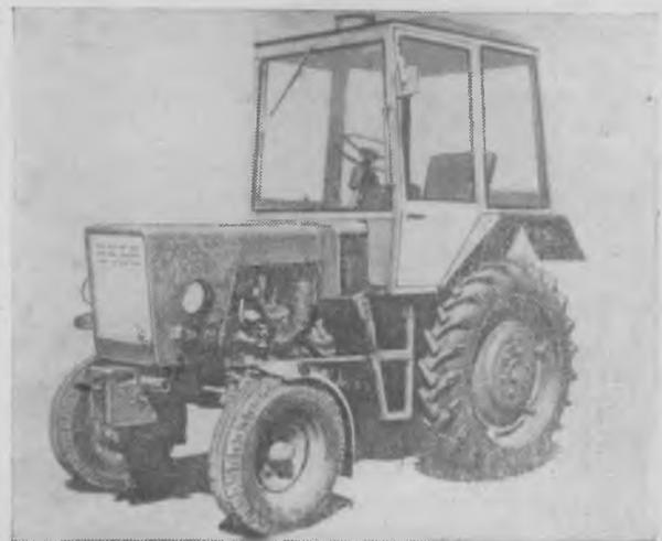
Трактор Т-25А класса тяги 0,6 тс
