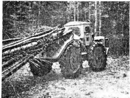
Рис. 3. Трактор Т-40АМ с активным полуприцепом, оборудованный щитом и лебедкой, на трелевке деревьев от рубок ухода
