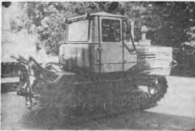
ранее выпускаемой модели Т-54В (на базе которого был разработан лесохозяйственный трактор Т-54Л) состоит главным образом в более мощном двигателе (51,5 кВт) и в ширине колеи (1100 мм вместо 950 мм), что обеспечивает лучшую поперечную устойчивость. Значительно улучшены условия труда тракториста, на амортизаторах установлена удобная кабина с большой площадью остекления. Имеется восемь передач переднего
