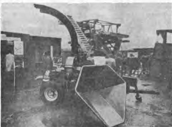
ра лебедки подсоединяется к трехточечной навеске сельскохозяйственного трактора общего назначения. В транспортном положении она опускается и укрепляется над трактором. Длина тягового каната — 430 м, максимальное тяговое усилие — 25 кН.
