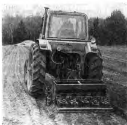
Рис. 3. Посев семян сеялкой «Литва-25»
