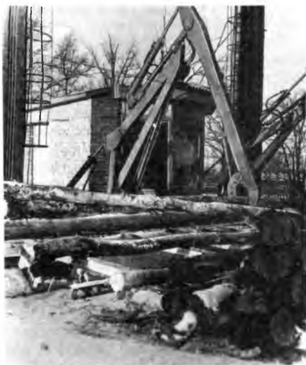
Раскряжевочная линия ЛО-15А, установленная на нижнем складе леспромхоза
