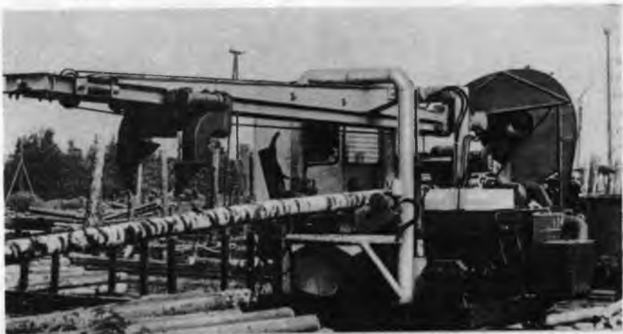
Рис. 1. Передвижная машина для раскрывки хлыстов и сортировки сортиментов
