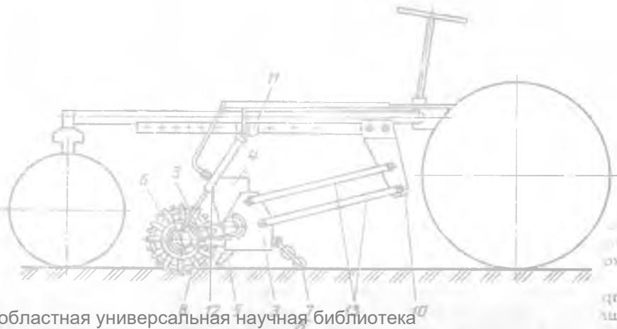
состоит из двух продольных швеллеров и двух поперечных уголков. Впереди к продольным брускам приварены кронштейны для присоединения бороздообразователя, к задней — боковины для установки семенного бункера. На кронштейнах имеются полуоси для крепления стоек (при задней навеске) или гидроцилиндров (при навеске на Т-16М). На левой боковине размещается звездочка привода высевających аппаратов.
