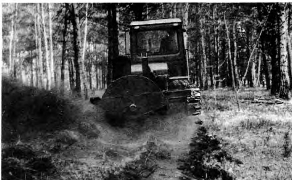
Рис. 2. Лесопожарный комплекс в работе
