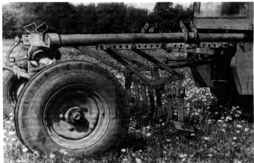
Рис. 3. Культиватор межстрочный КМС-1
