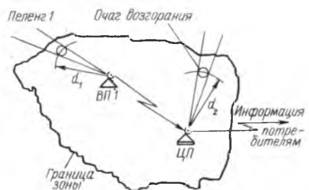
Рис. 1. Структура трехпозиционной пассивной системы с СВЧ-радиометром
