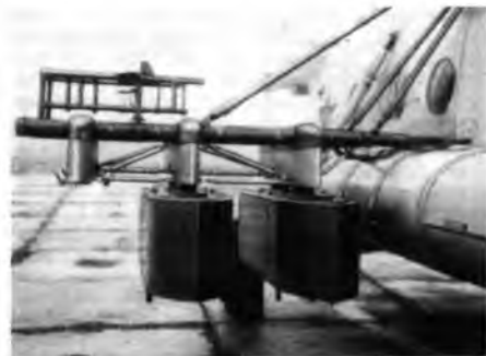
Рис. 2. Общий вид контейнеров с модулями, установленных на боковых фермах вертолета Ми-8МТ
