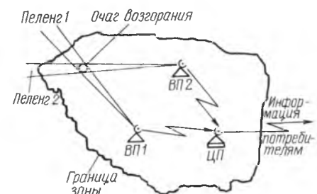
Рис. 1. Структура трехпозиционной пассивной системы с СВЧ-радиометром
