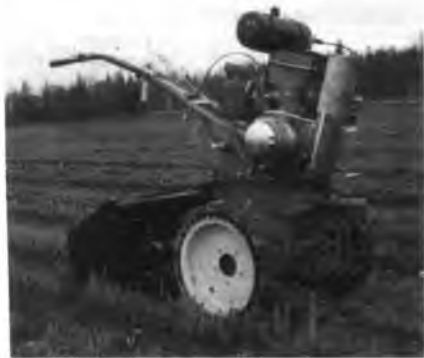
Мотоблок с дефорсированным двигателем ИЖ-«Планета» и культиватором фрезерного типа
