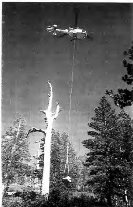
Рис. 4. Доставка груза на внешней подвеске вертолета
