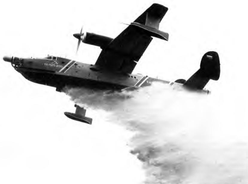
Рис. 2. Самолет-танкер Бе-12П для первой атаки на пожар (берет 6 т воды с водной поверхности в глиссирующем положении за 6 с)
