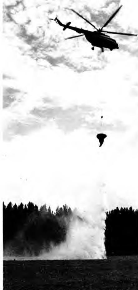
Рис. 3. Создание заградительной противопожарной полосы с помощью ВСУ-5 на вертолете Ми-8
