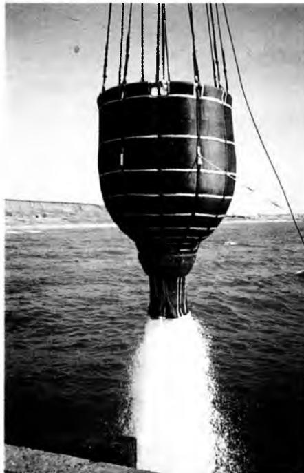
Рис. 2. Слив воды ВСУ-5 с регулирующим чехлом, уменьшающим расход с 900 до 600 л/с
