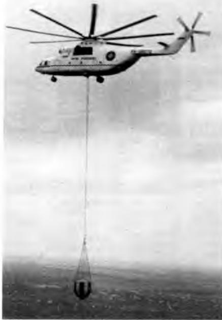
**Рис. 4. Транспортировка воды вертолетом Ми-26Т при помощи ВСУ-15 (объем емкости — 15 м<sup>3</sup>)**
