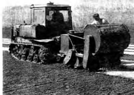
Рис. 2. Сеялка ПЛСШ-5/6 в агрегате с трактором ДТ-75М на посеве семян сосны
