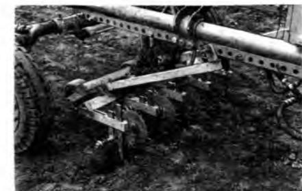
Рис. 3. Культиватор КПШ-1,25 на обработке почвы в посевах сосны
