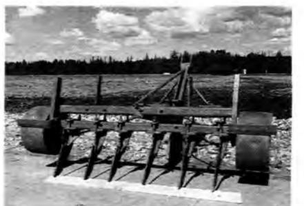
Рис. 3. Самодельное приспособление для вертикальной подрезки корней сеянцев ели
