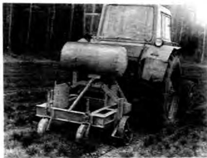
**Рис. 6. Корнеподрезчик КРПШ-1,2 в рабочем положении**
