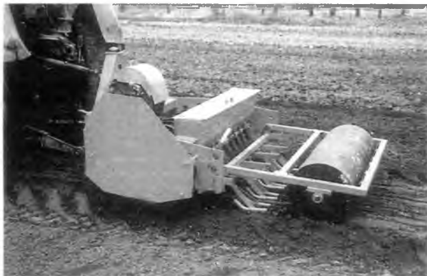
Рис. 1. Сеялка лесная модернизированная СЛН-5/9А
