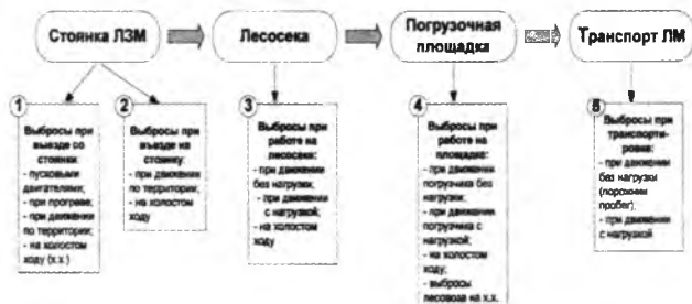
Рис. 1. Выбросы в атмосферу в процессе заготовки древесины
