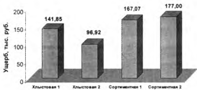
Рис. 2. Диаграмма ущерба от загрязнения атмосферного воздуха при применении различных технологий лесозаготовок и комплексов ЛЗМ
