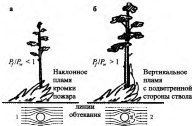
Рис. 4. Наклонное (а) и наклонно-вертикальное (б) положение пламенной зоны в зависимости от ламинарного (1) и турбулентного (2) режимов обтекания ствола
