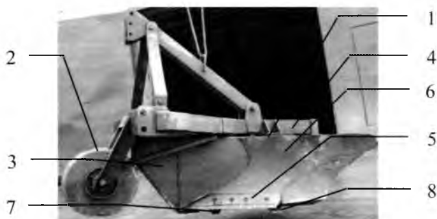
Общий вид почвообрабатывающего орудия для содействия естественному лесовозобновлению
