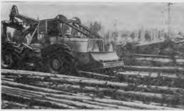
Рис. 3. Очистка стволов от сучьев с помощью ножей, смонтированных на бульдозерном отвале трактора
