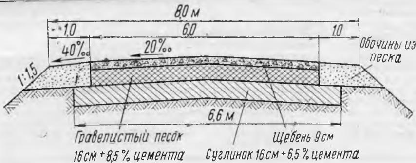
Рис. 3. Схема поперечного профиля опытного участка дороги
