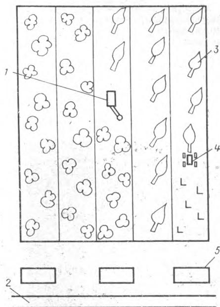
Рис. 3. Технологическая схема разработки лесосеки валочно-пакетирующей машиной «Дротт» при валке деревьев на параллельных лентах: 1 — машина «Дротт»; 2 — лесовозная дорога; 3 — пачка деревьев; 4 — трелевочный трактор; 5 — погрузочная площадка
