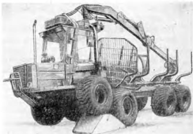
Рис. 3. Лесной колесный трактор высокой проходимости «Бруунет Мини 678»
