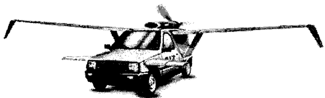
Рис. 2. Аэромобиль на базе автомобиля ВАЗ-1111 "Ока"
