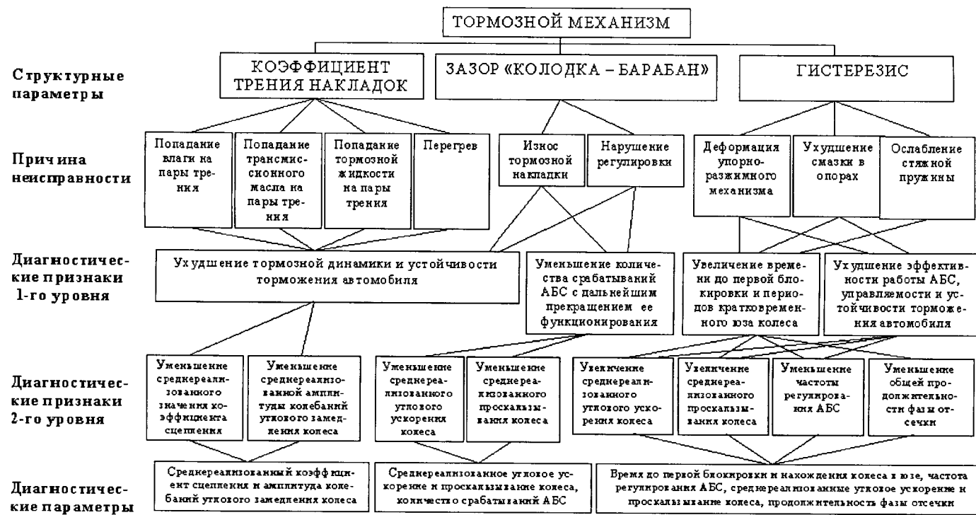
Рис. 4. Структурно-следственная схема диагностирования основных неисправностей пневматических тормозов автомобиля с АБС
