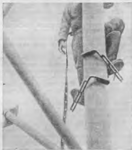
Рис. 4. Кошки для подъема на опору из стальных труб.
