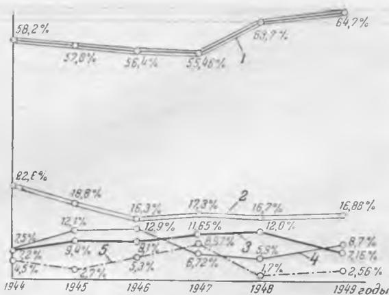
Рис. 2. Классификация случаев неправильных действий защиты „по условной виновности“ в целом по энергосистемам.
