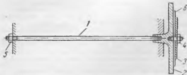
Рис. 2. Приспособление для обработки гребенчатых прокладок.
