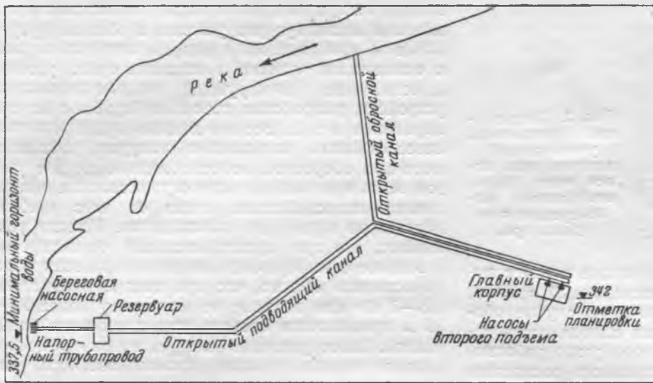
Рис. 4. Схема водоснабжения тепловой электростанции с двумя ступенями подъема воды.
