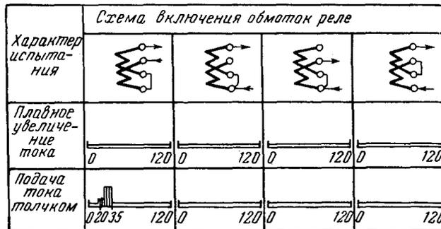
Рис. 3. Испытание на вибрацию реле ЭТ-521 после отказа в срабатывании при коротком замыкании на защищаемой линии.
