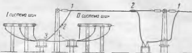
Рис. 1. Выполнение шинного моста линейной ячейки целым проводом.
