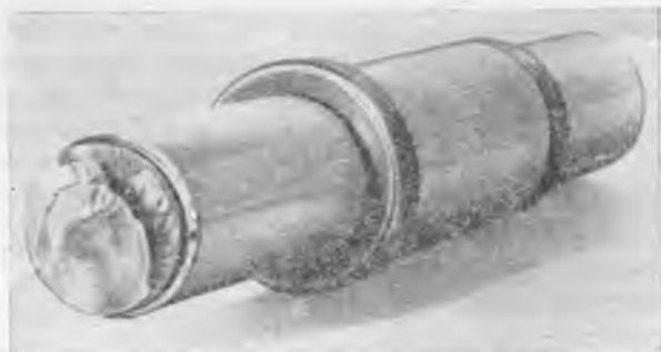
Рис. 2. Излом валика турбины 12 800 квт .
