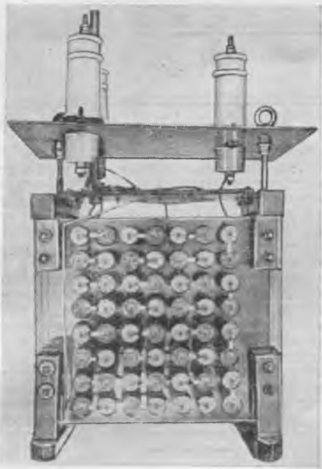
Рис. 2. Три секции селеновых столбиков, собранных на общем деревянном каркасе и закрепленных к крышке бака с выводными изоляторами и штангой переключателя секций.
