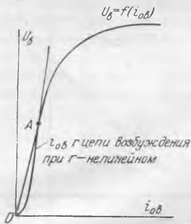
Рис. 1. Получение устойчивой точки возбуждения при нелинейном сопротивлении в цепи возбуждения.
