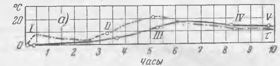
Рис. 9. Разность температур:верху шпильки и верхнего фланца слева (а); внизу шпильки и нижнего фланца слева (б);верху шпильки и верхнего фланца справа (в); внизу шпильки и нижнего фланца справа (г). Обозначения те же, что и на рис. 6.
