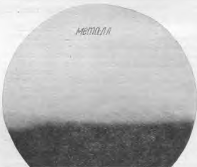
Рис. 8. Поверхность трубки под обесцинкованной пленкой после 22 кислотных промывок. \times 100 .
