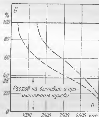
Рис. 6. График расхода теплоносителя по продолжительности.
